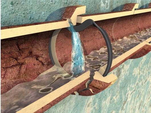
Im Zuge dieser Kanalreinigungsarbeiten kann es vorkommen, dass bei Gebäuden, welche keine ordnungsgemäße Stragentlüftung an der Hauskanalisation haben, ein Unterdruck im Rohr entsteht. Dadurch kann sich das Sifon der Sanitäranlagen entleeren und es in der Folge zu einem Rückstoß in den Abflussrohren kommen.
